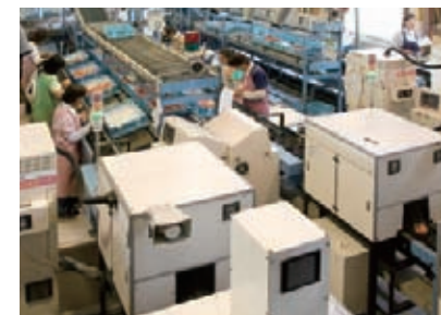
桃は光センサーで階級・等級別に仕分けられ、自動的に計量、箱詰めされる
